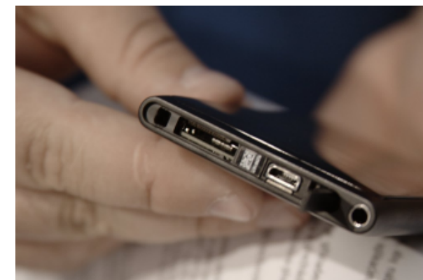
Odhalené konektory (SIM, mikro USB, jack)
