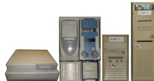
Ukážka časti pôvodného serverového vybavenia: Zľava dns a dhcp server, prvý linuxový file-server (s nálepkou tučniaka) a dva servery slúžiace ako LDAP a Samba
