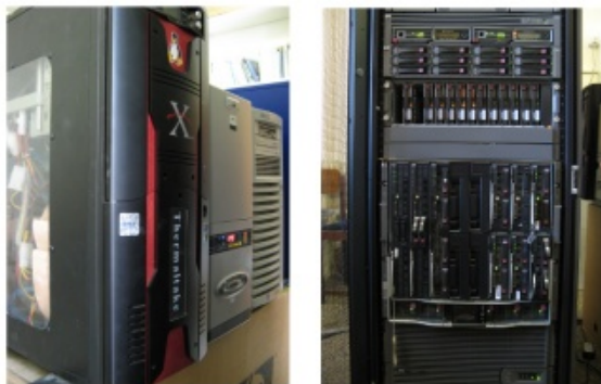
Serverová infraštruktúra samozrejme prebiehala postupnými upgradami, vľavo server na ktorom bežal ISS, vpravo v súčasnosti používaný HP blade c7000
