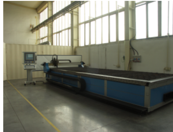
Plazmový rezací stroj s riadiacim systémom na platforme Linux - RTAI
